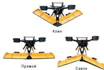
Meyer Super-V, благодаря изменяемой геометрии ковша, позволяет вести уборку снега используя различные приемы. Гидравлические цилиндры двойного действия позволяют поменять геометрию и зафиксировать ковш именно в том положении которое необходимо Вам в данный момент, причем, прямо в процессе уборки.
